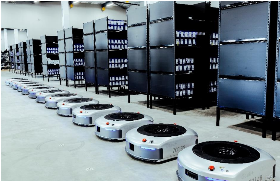
「プロロジスパーク千葉ニュータウン」倉庫内の無人搬送ロボット
